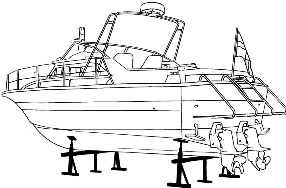
Schwerlast Stahl-Unterstellbock in verschiedenen Ausführungen und mit einer Traglast von 500 bis 10.000 kg/Unterstellbock – passend für die meisten Motorboote.
