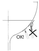
Drehen Sie die Stütze so, dass sie zur Mittellinie des Bootes zeigt.
