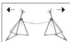
HINWEIS! Stützenpaare immer mit einer Sicherungskette verbinden!
